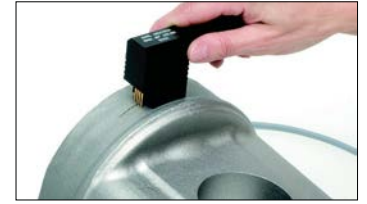
在確定裂紋的角度後，對斜裂紋深度的測量
